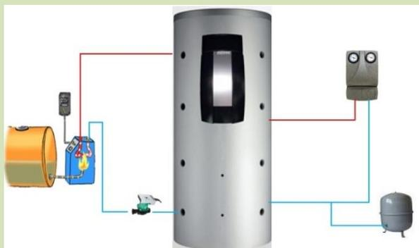
Abbildung 7 Schema einer Bestandsheizungsanlage mit Bestandspufferspeicher und Frischwasserstation
